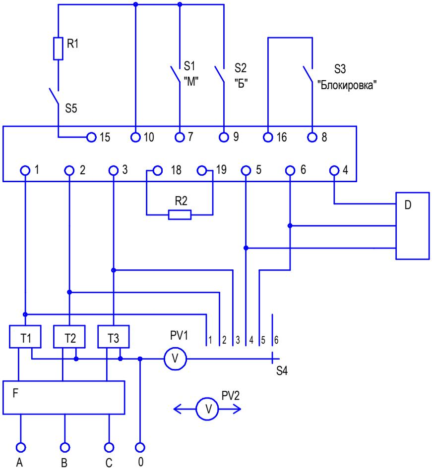
F - автомат защиты типа АП-50 ЗМТ с током отсечки 4 А
