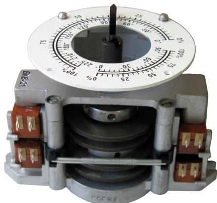
Блоки БКВ-21, БКВ-21-Т, БКВ-21А, БКВ-21А-Т (далее – блоки) предназначены для сигнализации в крайних или промежуточных положениях выходного органа.
