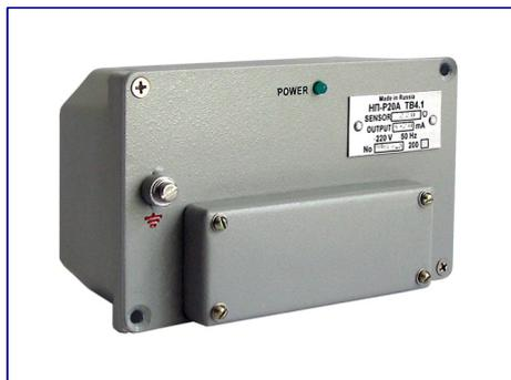
Нормирующий преобразователь НП-Р20А (далее - преобразователь) предназначен для усиления и преобразования сигналов потенциометрических датчиков (ПД) исполнительных механизмов в унифицированный выходной сигнал силы постоянного тока по ГОСТ 26.011-80 в системах автоматического регулирования АЭС.
