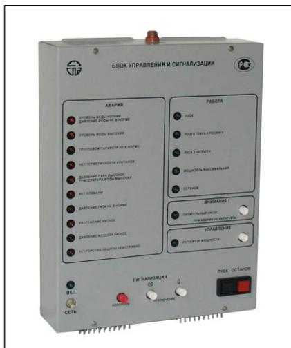
Блок управления и сигнализации БУС15 (в дальнейшем – блок) предназначен для автоматического управления тепловой установкой, работающей на газообразном топливе: паровым или водогрейным котлом малой мощности (до 3,0 МВт), горелками хлебопекарных, обжиговых печей, сушильных камер, агрегатов приготовления витаминной муки, теплогенераторов, устройствами розжига горелок установок средней мощности. Возможно применение блока для автоматизации тепловой установки, работающей на жидком топливе.
