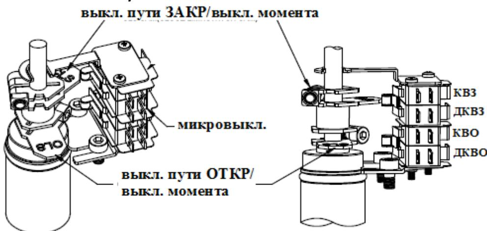
**6.9.1** Пожалуйста, потяните ручку рычага «ручной/автоматический» в положение «ручное» и поверните ручным штурвалом привод в положение по часовой стрелке до полного закрытия арматуры.
